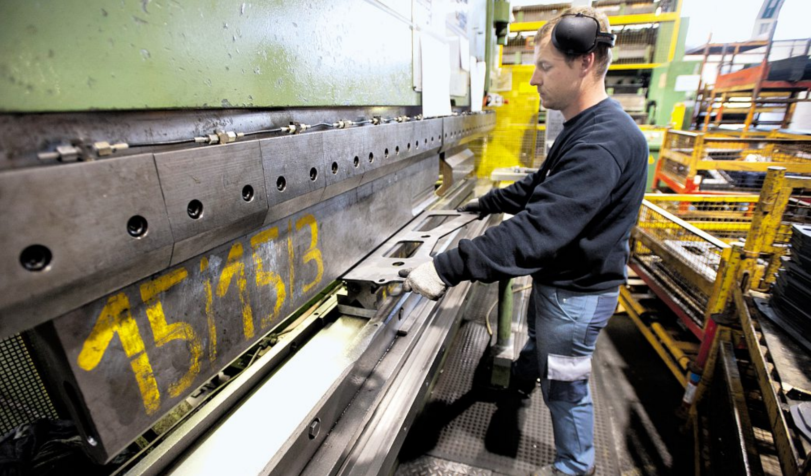
Schwerarbeit an der Gesenkbiegepresse: Jedes Dickblechteil, das eingelegt werden muss, wiegt zwölf Kilo.
