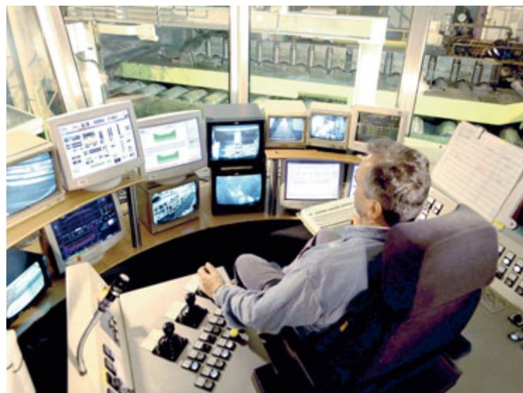
Technische Überwachung auf dem Steuerstand der Warmwalze.
