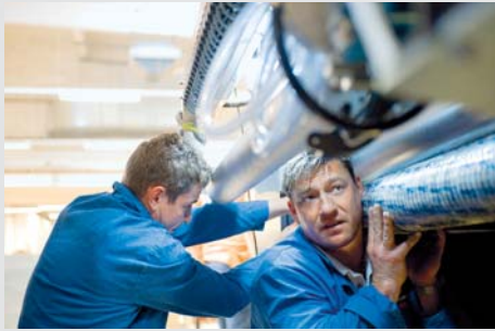
Die Walze des Falzapparats wird eingesetzt. Hier bekommen die Papierbögen ihr Format.
