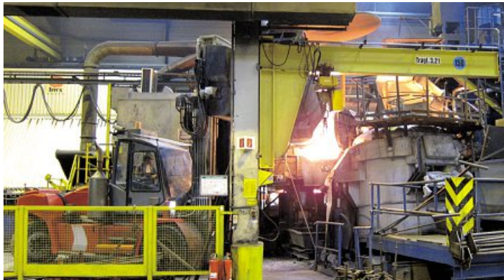
Ein besonderer Moment für die Besucher: Ein Spezialstapler füllt flüssiges Metall in den Vergießbofen
